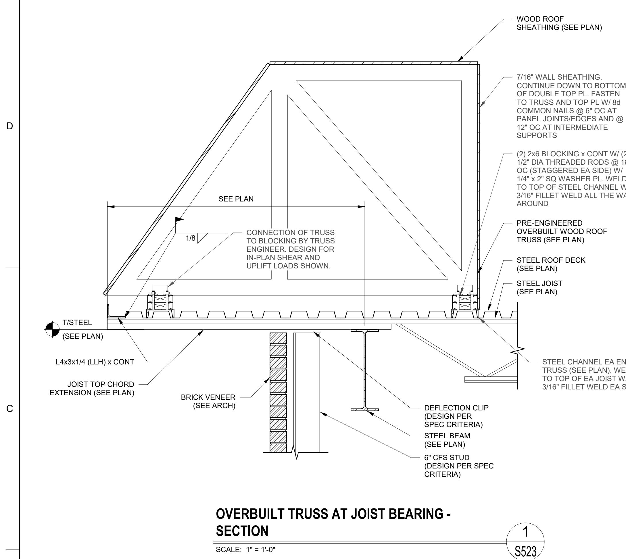
OVERBUILT TRUSS AT JOIST BEARING - SECTION
